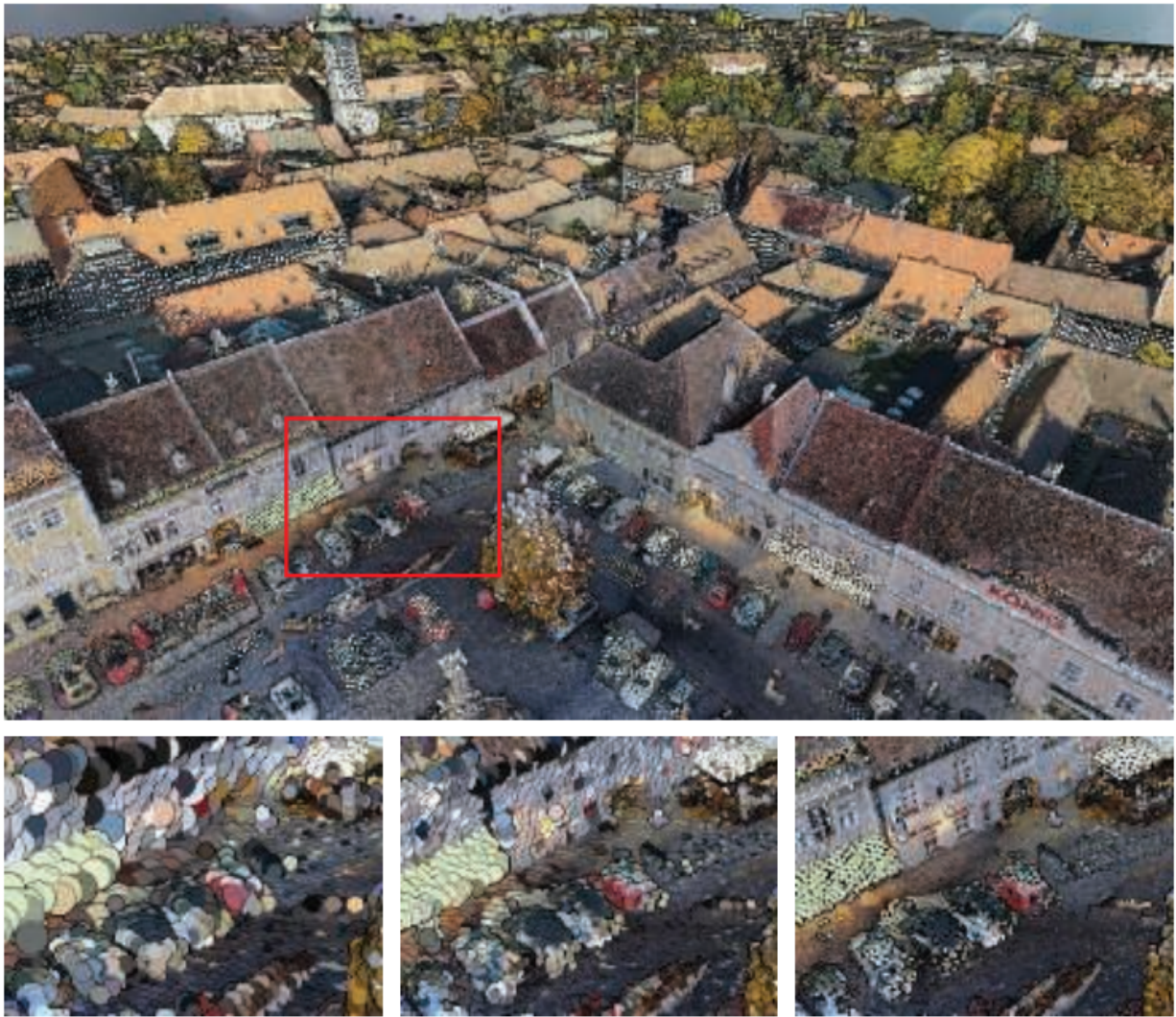
图 13.24：选择其中的 500 万个点来渲染一个包含 1.45 亿个点的小镇数据集。通过检测深度差异来增强边缘。当点云数据稀疏或者广告牌半径太小时，就会出现空洞。底部一行是图像预算分别为 50 万个点、100 万个点、500 万个点时所对应的渲染结果。[1583]
