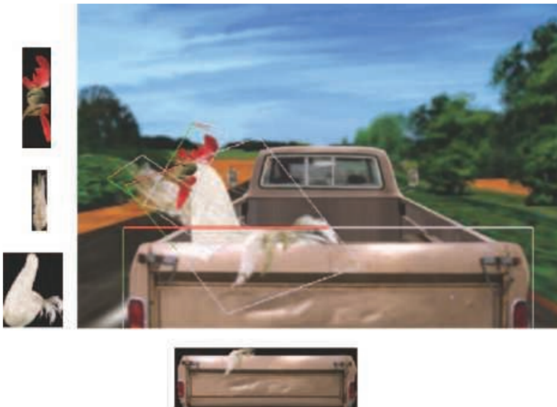
图 13.3：动画《Chicken Crossing》的一帧画面，使用 Talisman 模拟器进行渲染。在这个场景中，使用了 80 层 sprite，其中一些被突出显示在左侧。由于鸡翅一部分位于后挡板的前面，一部分位于后挡板的后面，因此二者被放置在了独立的 sprite。
