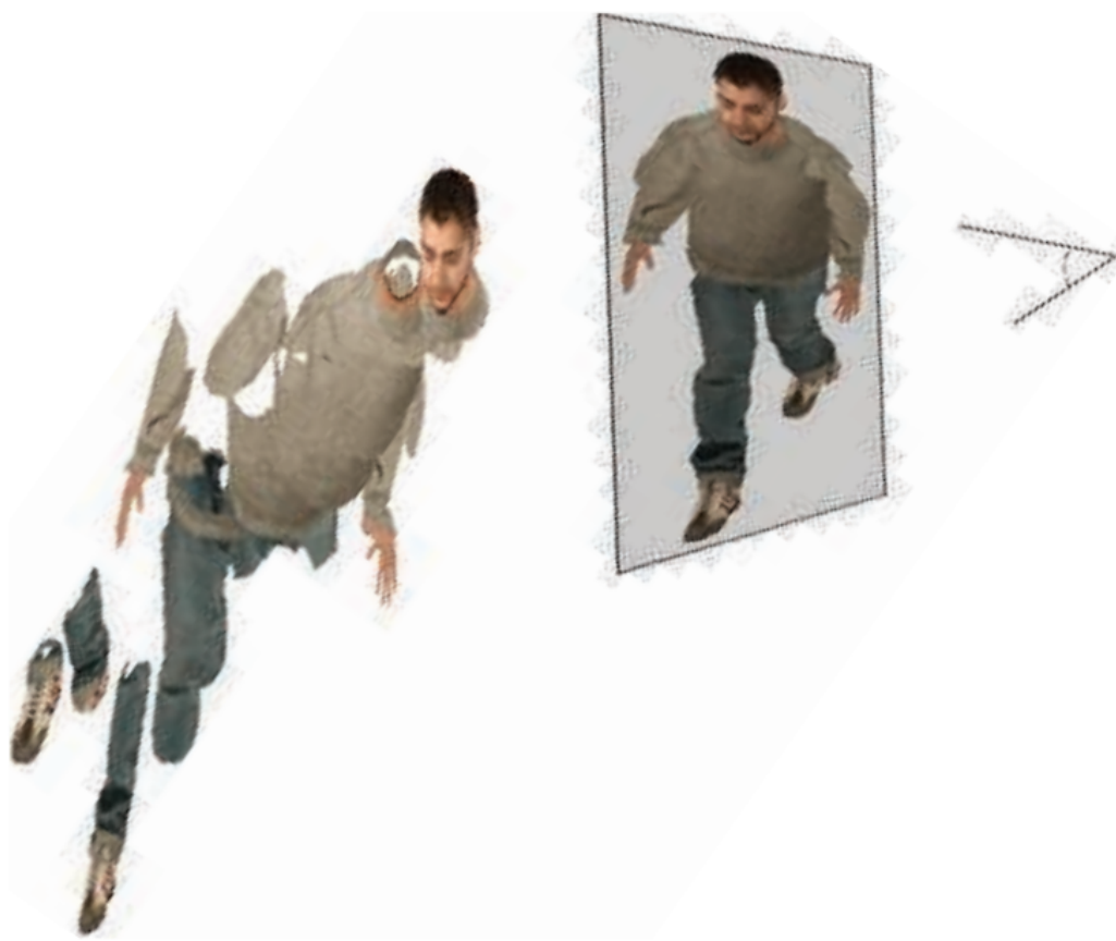
图 13.14：一种 impostor 技术，其中每个单独的动画元素都由一组图像进行表示。这是在一系列遮挡和合成操作中进行渲染的，将这些操作结合起来，能够在给定视图下构建一个令人信服模型。 [122]
