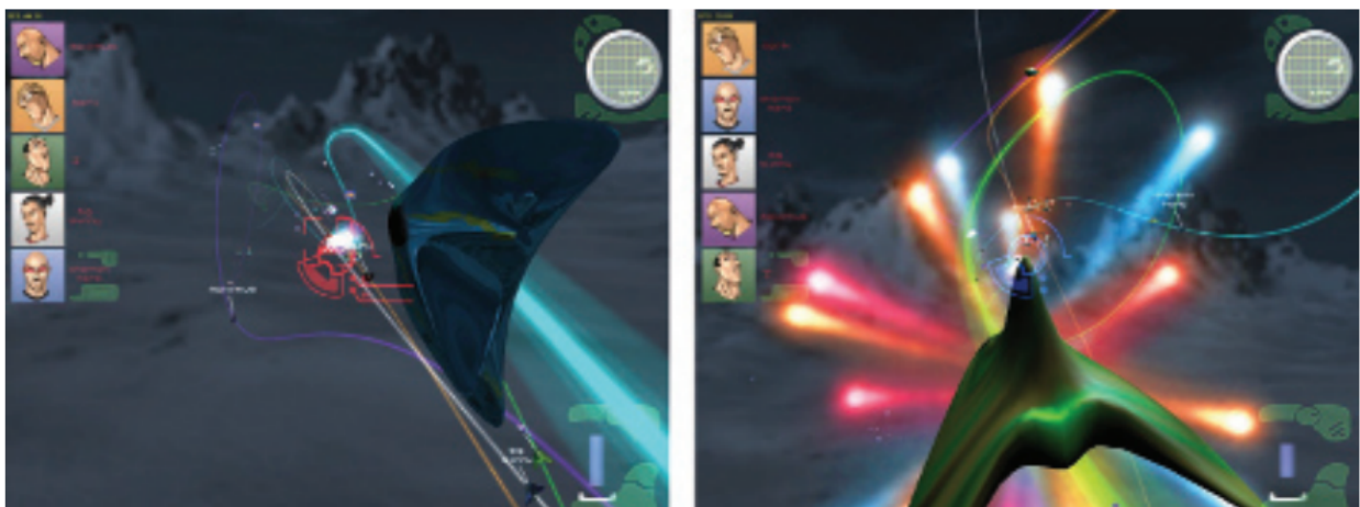
图 13.12：使用广告牌的例子。图中平视显示（heads-up display, HUD）图形和星形弹道（projectile）都是屏幕对齐的广告牌。右图中巨大的泪滴状爆炸是一个面向视点的广告牌。曲线光柱是由一组相连四边形组合而成的轴向广告牌。为了创建一个连续的光柱，这些四边形会在它们的角上彼此连接，因此它们不再是严格的矩形。
