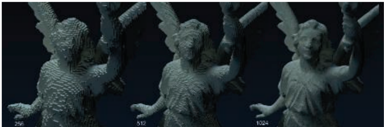
图 13.29：不同 LOD 下的体素光线追踪结果。沿着包含模型的体素网格边缘，从左到右的分辨率分别为 256，512 和 1024。 [753]
