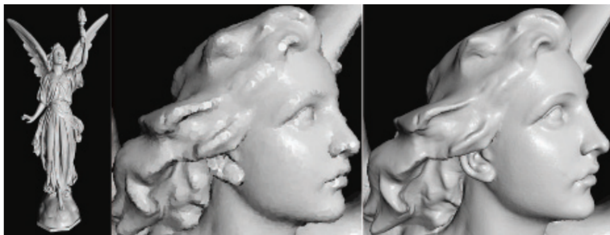
图 13.22：这些模型使用了基于点的渲染方法，并使用圆形 splat 进行渲染。左图展示的是天使露西的完整模型，它包含 1000 万个顶点。然而，在实际渲染中只使用了大约 300 万个 splat。中间和右边的图片放大了头部细节。中间的图像在渲染期间使用了大约 4 万个 splat。当观察者停止移动时，结果会逐渐收敛成右侧的图像，它包含 60 万个 splat。
