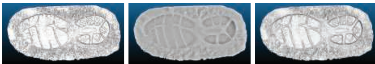
图 13.25：左侧：具有法线数据的点在一个单独的 pass 中进行渲染。中间：一个没有法线数据的点云，使用屏幕空间环境光遮蔽进行渲染。右边：同样是没有法线数据的点云，使用 EDL 进行渲染。后面两种方法都需要额外执行一个 pass，从而建立图像中的深度缓冲。
